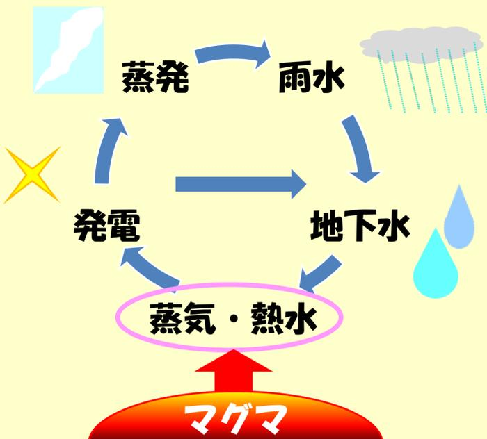
蒸気・熱水の元となる水は状態を変えながら大気と地下を循環しています
